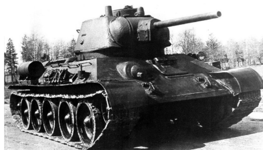
Предсерийный средний танк Т-34-76 с улучшенной «шестигранной» башней и командирской башенкой. 1943 год, июнь
